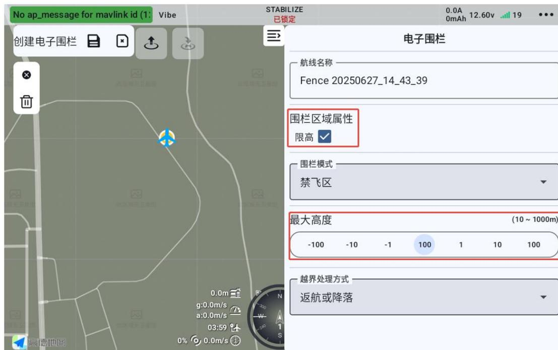
开启限高功能后，选择最大高度，则无人机在飞行时的高度只能处于最大飞行高度以下。
