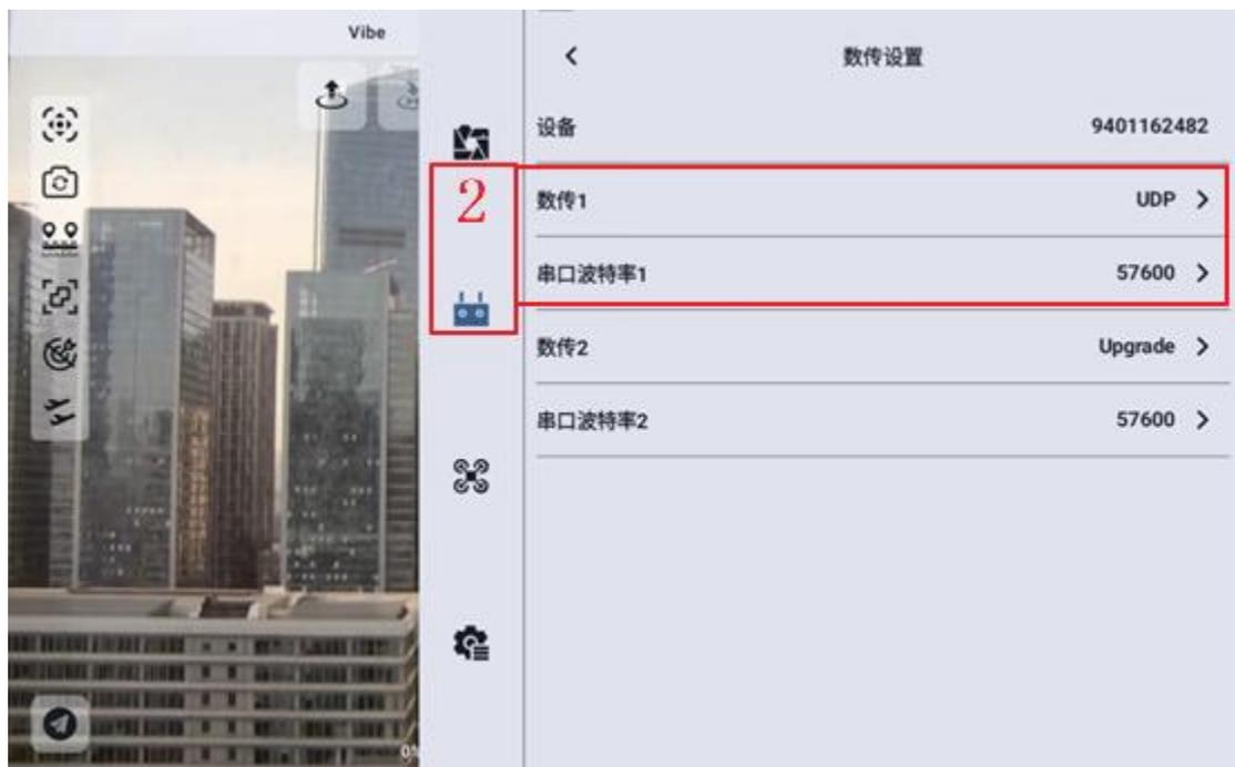
步骤三：将连接方式设置为 UDPCL 点击连接，根据提示填入地址，点击确认即可连接
