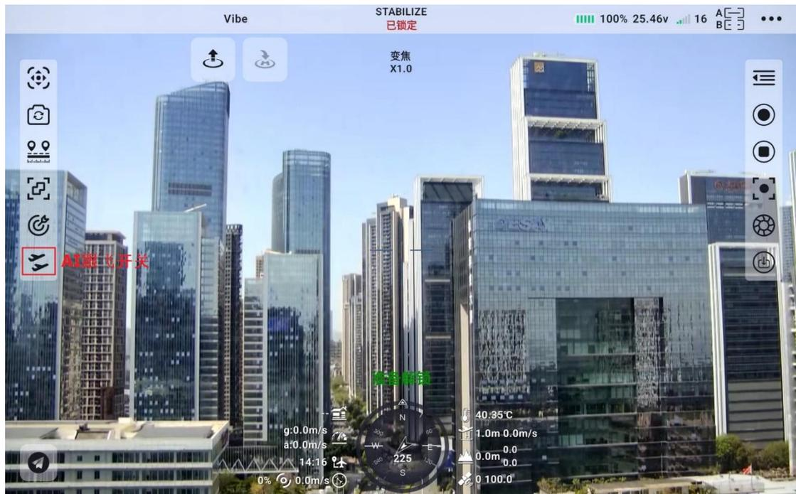
思翼光电吊舱（云台相机）可以通过思翼 AI 跟踪模块连接天空端，并在天空端与地面站通信状态下通过本应用实现 AI 识别跟踪与跟飞功能。
