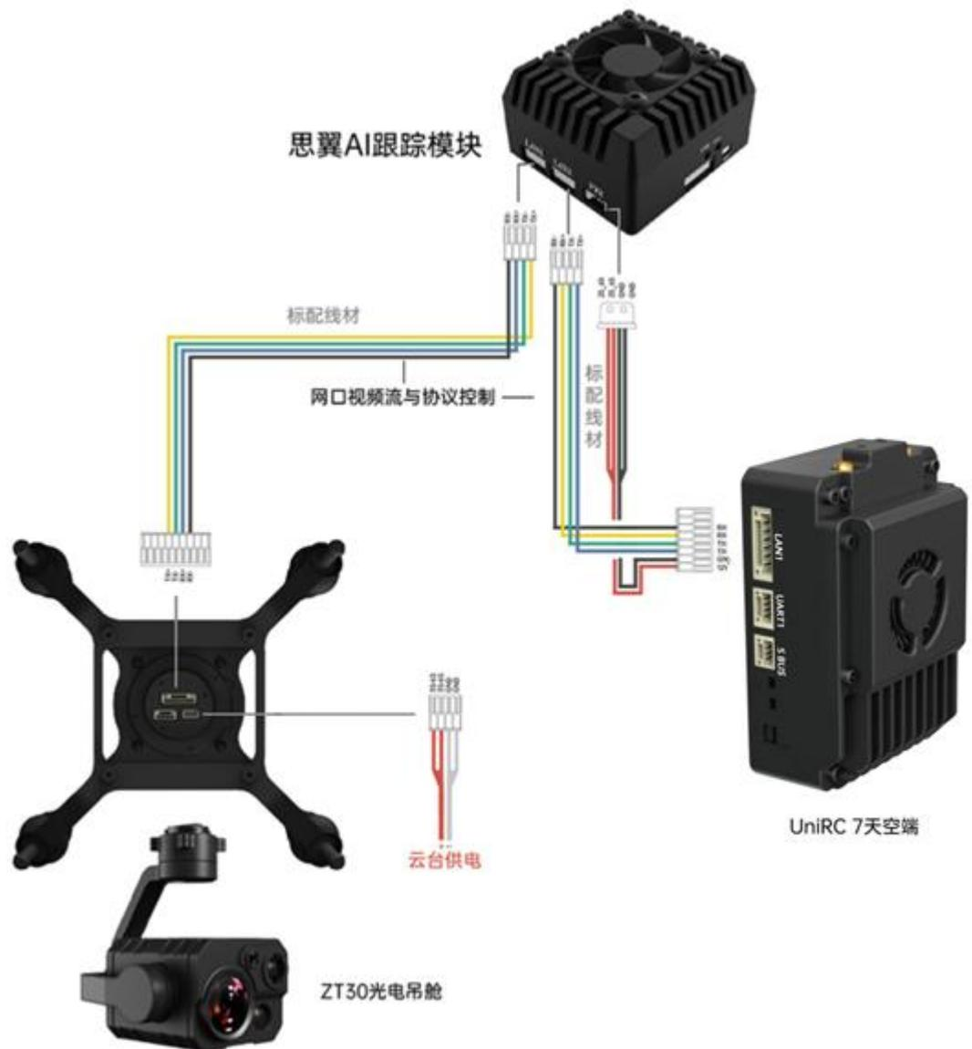
4. 参考下图连接思翼云台相机（光电吊舱）和飞行控制器并融合飞控姿态数据；
