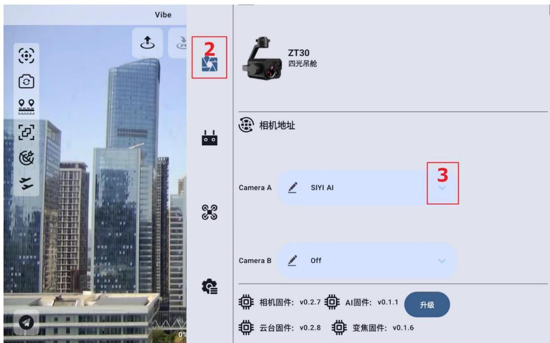
步骤三：点击相机地址栏倒三角，选择正确的相机地址。或者点击铅笔符号，根据提示手动输入相机地址
