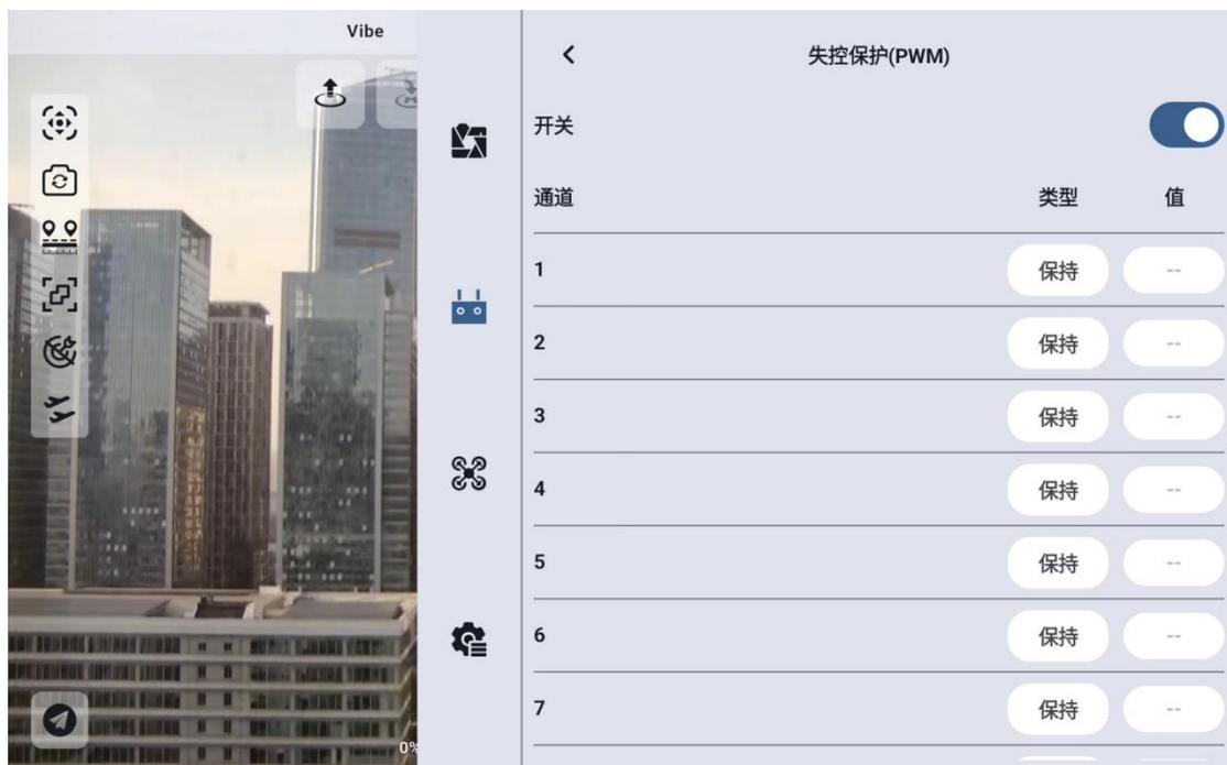
3. 失控保护功能默认关闭，左边的数字代表通讯通道，未设定失控保护输出通道值时，通道输出值默认显示“保持”。
