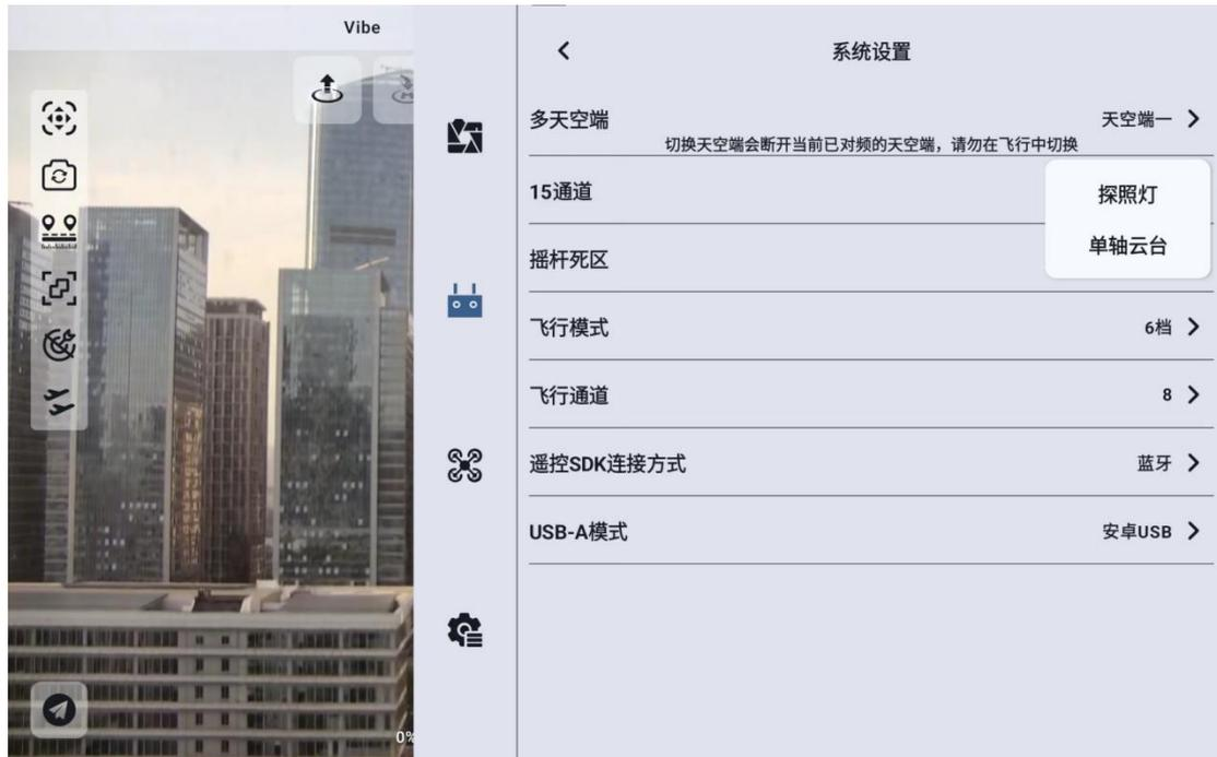
**注** 15 通道对应天空端接入 LAN 1 接口的设备，16 通道对应天空端接入 LAN 2 接口的设备，16 通道默认为探照灯
