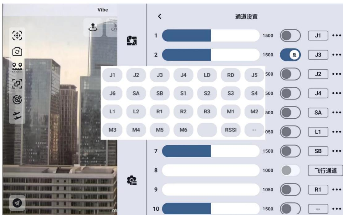
选中目标通道，点击通道映射按钮，弹出开关列表，选择所需要的开关，即可成功连接。
