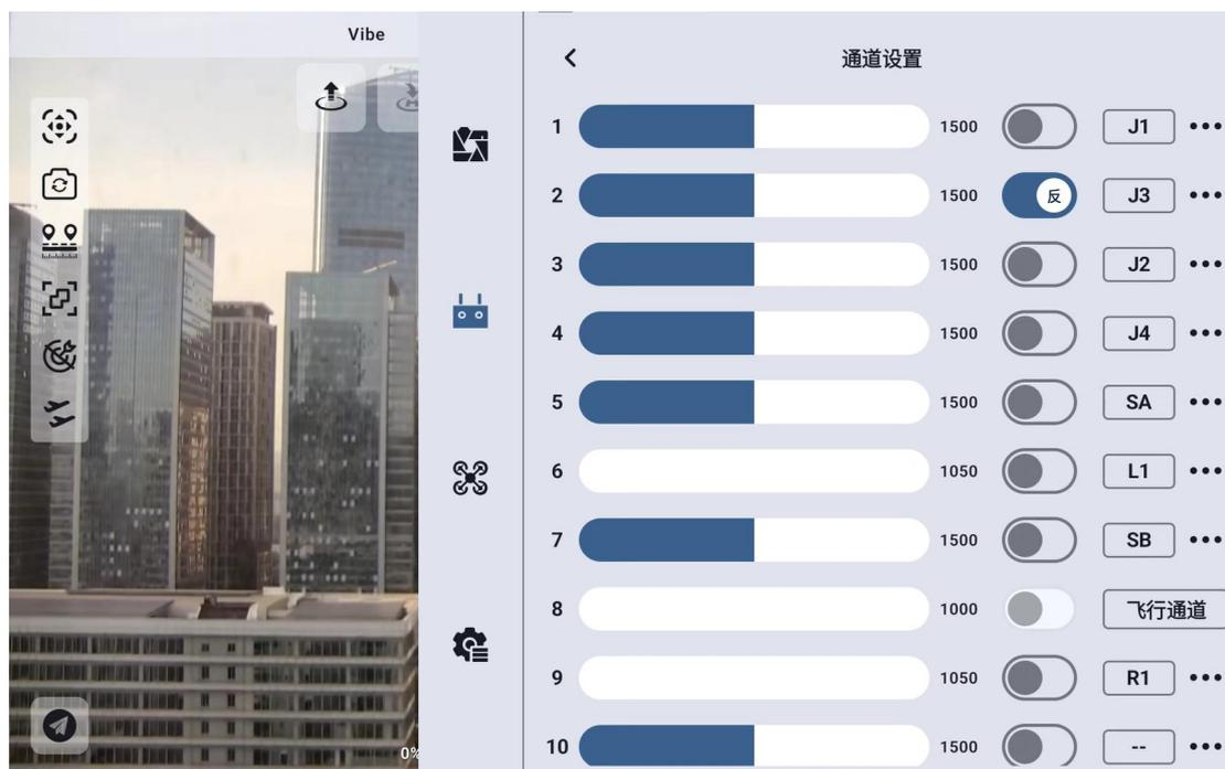
选中目标通道，点击对应的舵机正反向开关即可成功设置舵机正向和反向。
